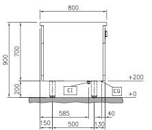
Electrical inlet (power) EQ Equipotential screw
